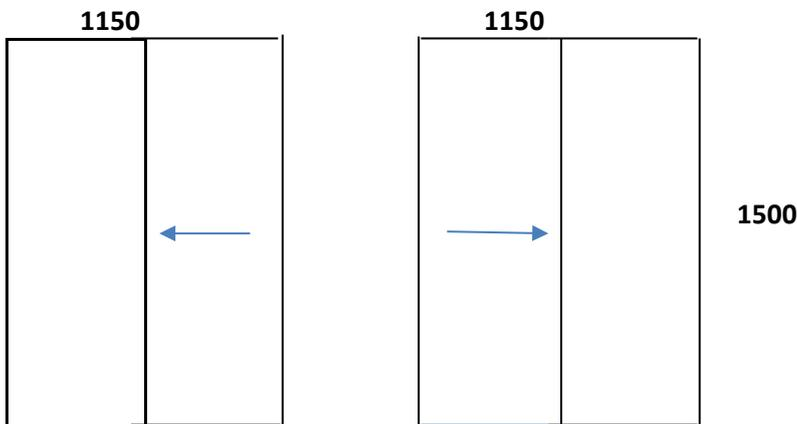
Алюминевые рамы (Хрущёвка) П-образная высотой 1500мм
